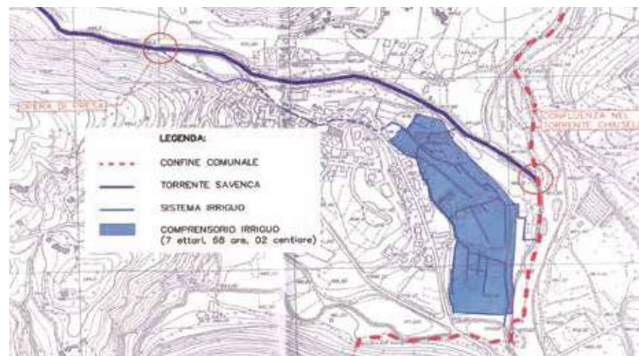
• Valchiussella – Comune di Issiglio: Sistema irriguo con presa su Torrente Savenca.
